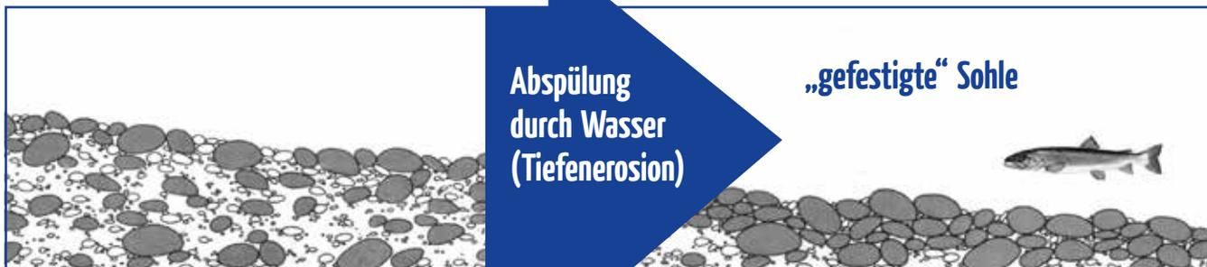
Wird in einem Flussabschnitt an der Sohle mehr Geschiebe abgetragen als von flussauf nachkommt, wird zunächst das feinere Material vom Fluss abtransportiert. Zurück bleiben die größeren Kiesanteile, man spricht von einer
