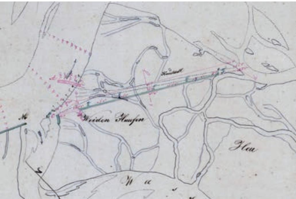
Abb. 2.38 Plan zur Verbesserung der Schiffbarkeit im „Holler“ zwischen Wallsee und Ardagger mithilfe eines 2,3 km langen Durchstichs durch den Weidenhaufen 1832 (Ausschnitt)
