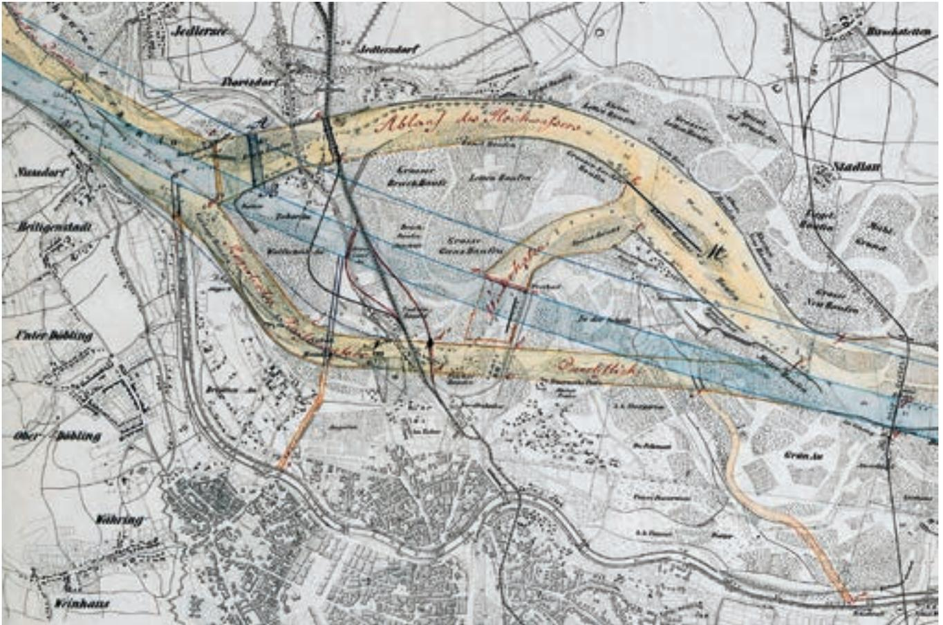
Abb. 3.5 Vorschlag zur Wiener Donauregulierung aus dem Jahr 1868, der den Ausbau des Kaiserwassers als neuen Hauptstrom vorsah. Der damalige Hauptstrom im Norden (heutige Alte Donau) sollte als Hochwassergerinne ausgebaut werden. (Blau eingezeichnet ist das 1870 bis 1875 ausgeführte Projekt).
