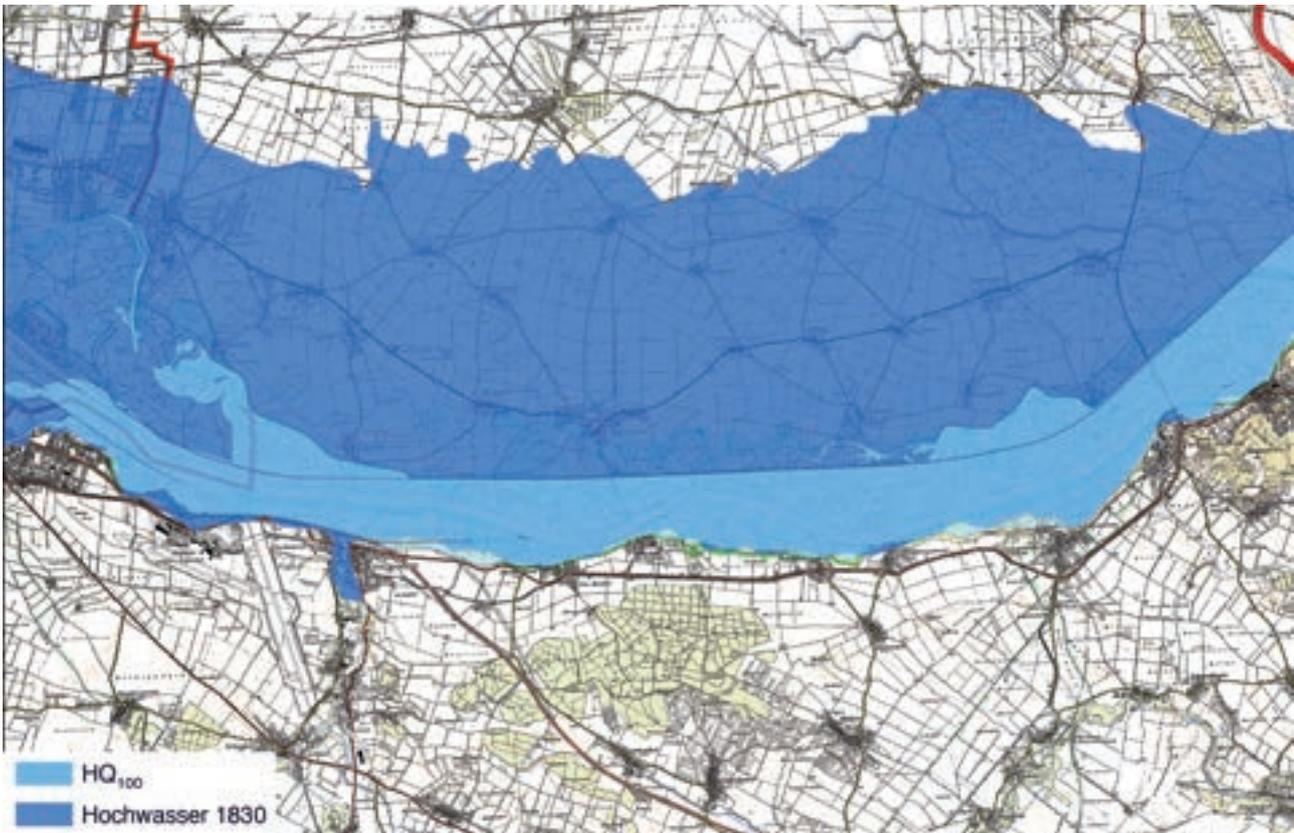
Abb. 2.27 Im Tullnerfeld war das Eisstau-Hochwasser 1830 ungefähr mit einem 100-jährlichen Hochwasser (HQ<sub>100</sub>) vergleichbar (Bild oben). Im Marchfeld wurden hingegen wesentlich größere Flächen überflutet, die heute vom Hubertusdamm und vom Marchfeldschuttdamm vor Hochwässern geschützt sind (unten).
