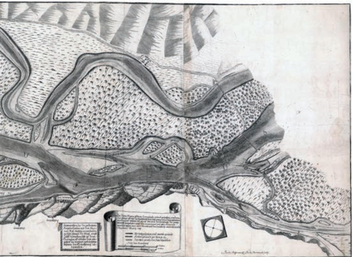
Abb. 2.9 Planunggrundlage für die Regulierung des oberen Donaukanals erstellt vom Wasser- und Brückenbaumeister Hoffmann von Anckherschron im Jahr 1700 (unten Mitte: Nussdorf mit dem damaligen Nussdorfer Sporn; Ausschnitt)
