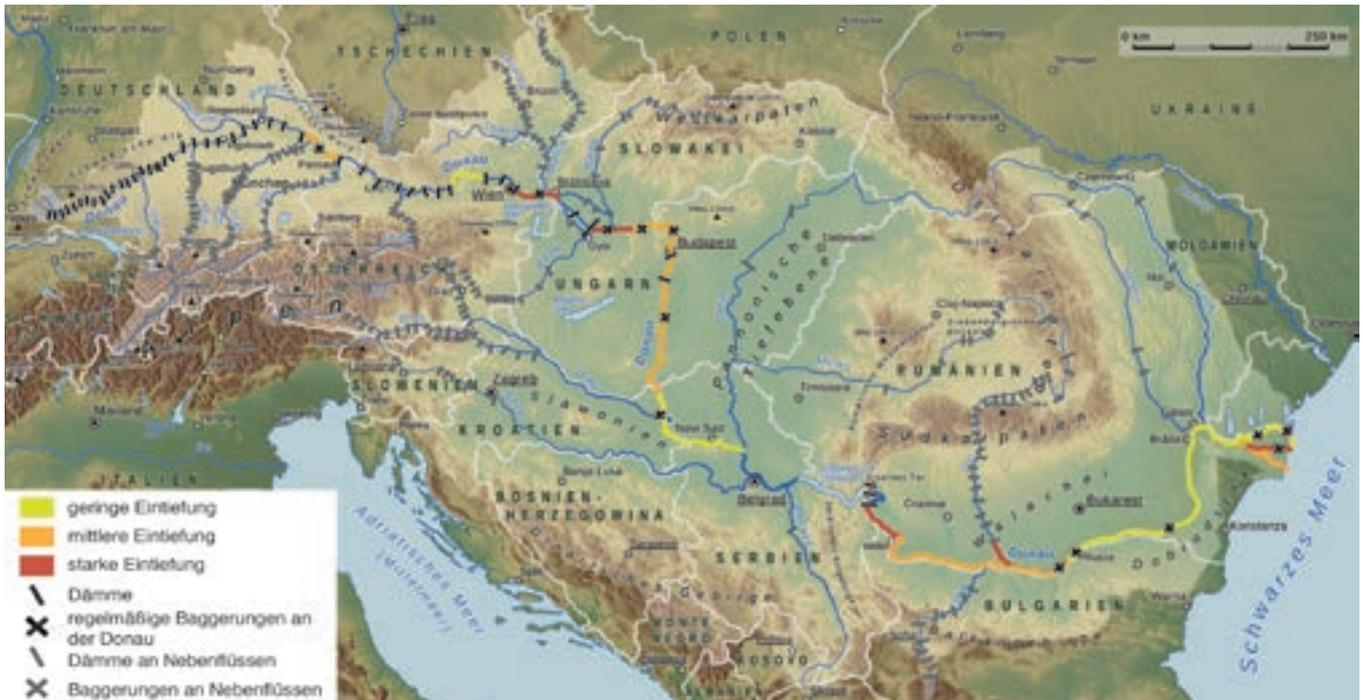
Abb. 1.12 Sohleintiefungen und Geschiebeentnahmen an der Donau und ihren größeren Zubringern
