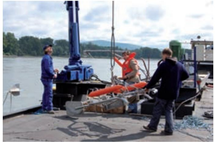
Abb. 4.41 Ein Gerät zum Sammeln von Geschiebeproben (Kies) wird in die Donau gehievt.
