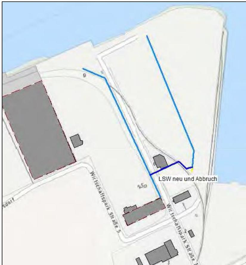
Abbildung 6: Bestehende (hellblau) / in Errichtung (dunkelblau) befindliche Lärmschutzwände
