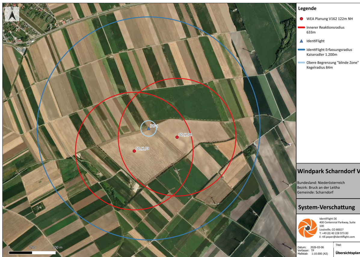
Abbildung 18: Abdeckung blinder Zonen durch benachbarte IdentiFlight
