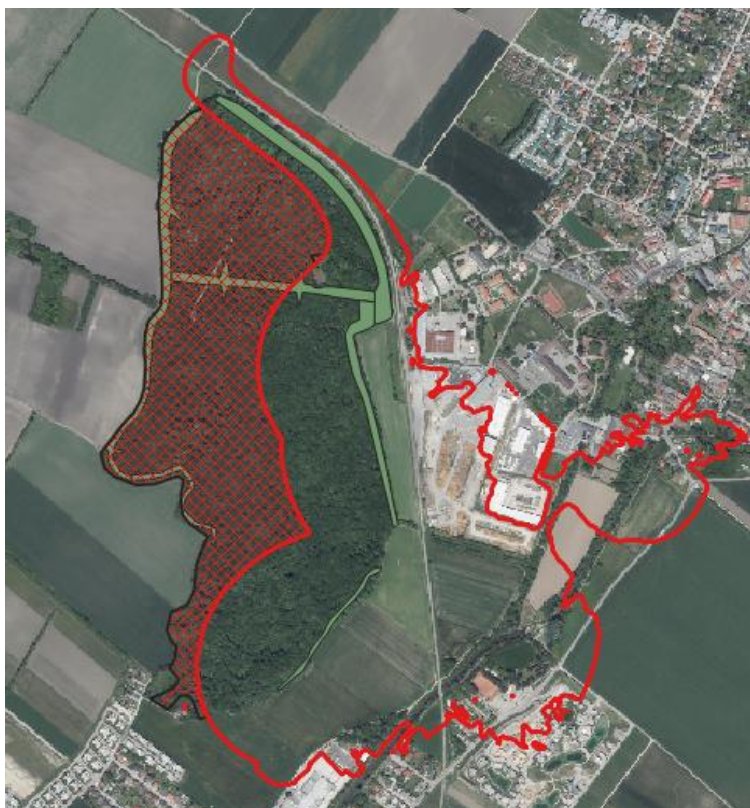
Abbildung 3: Maximaler Lärmpegel >58 dB (innerhalb der roten Linie) im Baujahr 6 im Bereich der Trumauer Au in den Monaten März-Mai. Rot schraffiert (34,69 ha) sind jene Bereiche mit einem maximalen Lärmpegel < 58dB.
