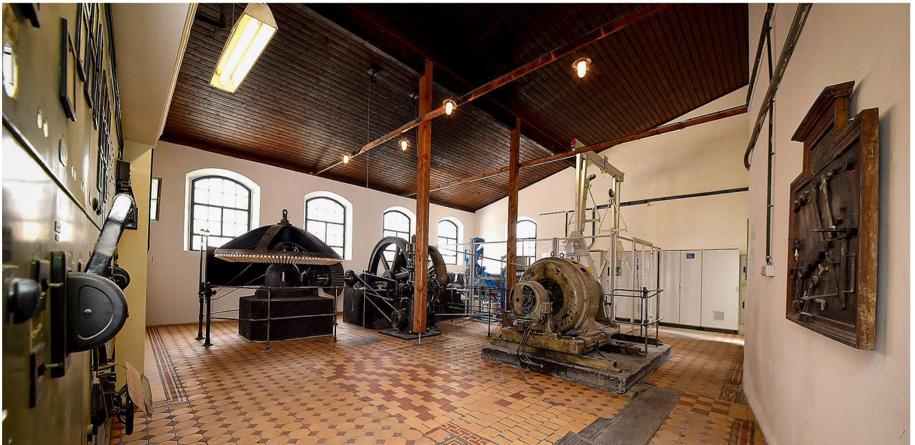
*Francis-Turbine eines stillgelegten Kleinkraftwerks (links)*
