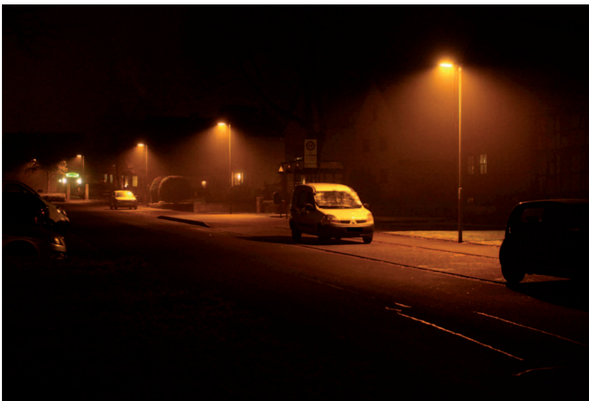
Abb. 29: Abgeschirmte Leuchten beleuchten nur die Straße und blenden dabei nicht
