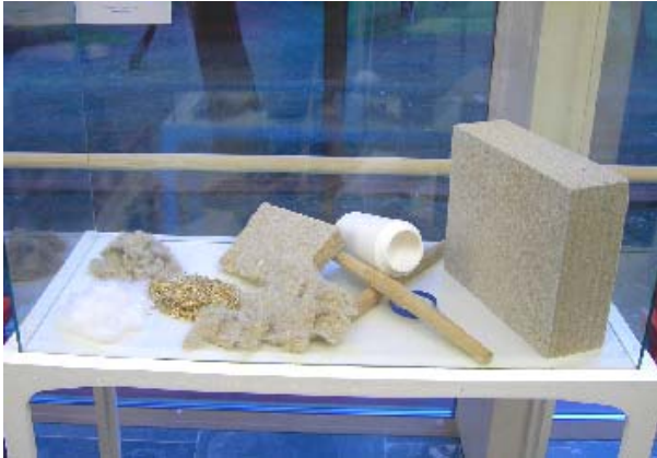
Rohstoffe zur Herstellung von Naturfaser Zwischenwänden.
