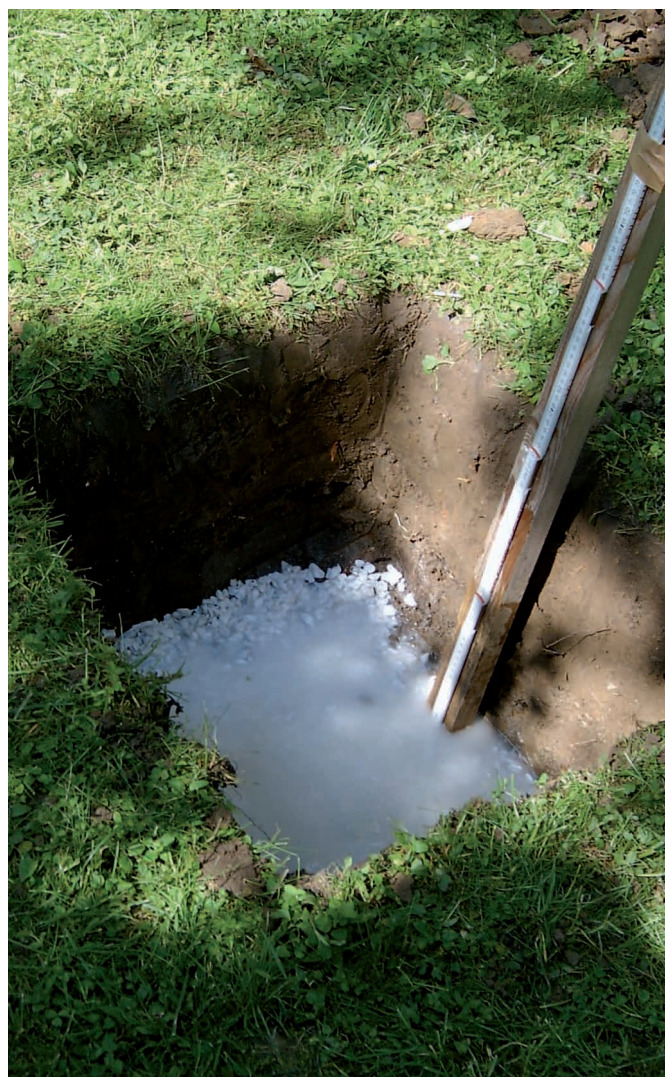
Abb. 8: Sickerversuche geben Auskunft über die Sickerfähigkeit der Böden
