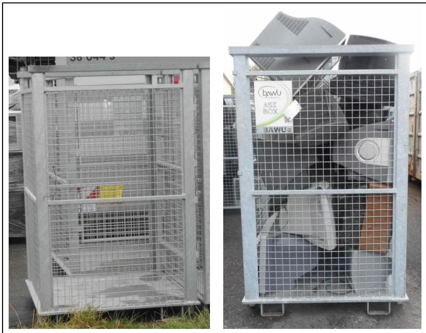
Abbildung 2: Gitterboxen zur Lagerung von „EAG mit großen Li-Batterien (Quelle: NÖ BAWU).
