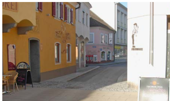
Abbildung 12: Fahrbahnanhebung und Belagswechsel am Beginn der Begegnungszone (Pöchlarn, Thörringplatz; Foto entgegen der Fahrtrichtung)
