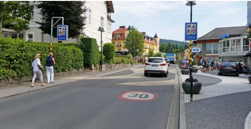
Abbildung 13: Das einheitliche Muster auf der Fahrbahn und am Gehsteig akzentuiert den Beginn der Begegnungszone (Velden am Wörthersee).
