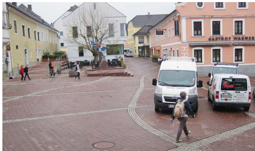
Abbildung 1: Tempo-30-Zone mit markanter Oberfläche und Aufenthaltsbereich als Beispiel für eine gute Gestaltung, die niedrige Kfz-Geschwindigkeiten bewirkt und flächiges Queren fördert (Haag, Stadtplatz).
