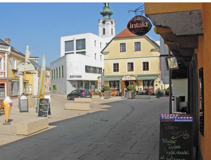
Abbildung 11: Betonquader bewirken eine verschwenkte Fahrlinie und definieren geschützte Geh- und Aufenthaltsbereiche (Pöchlarn, Thörringplatz).
