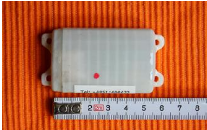
Abbildung 24: Ein batteriebetriebener GPS-GSM-Sender (© WG Dürrenstein, Christoph Leditznig).
